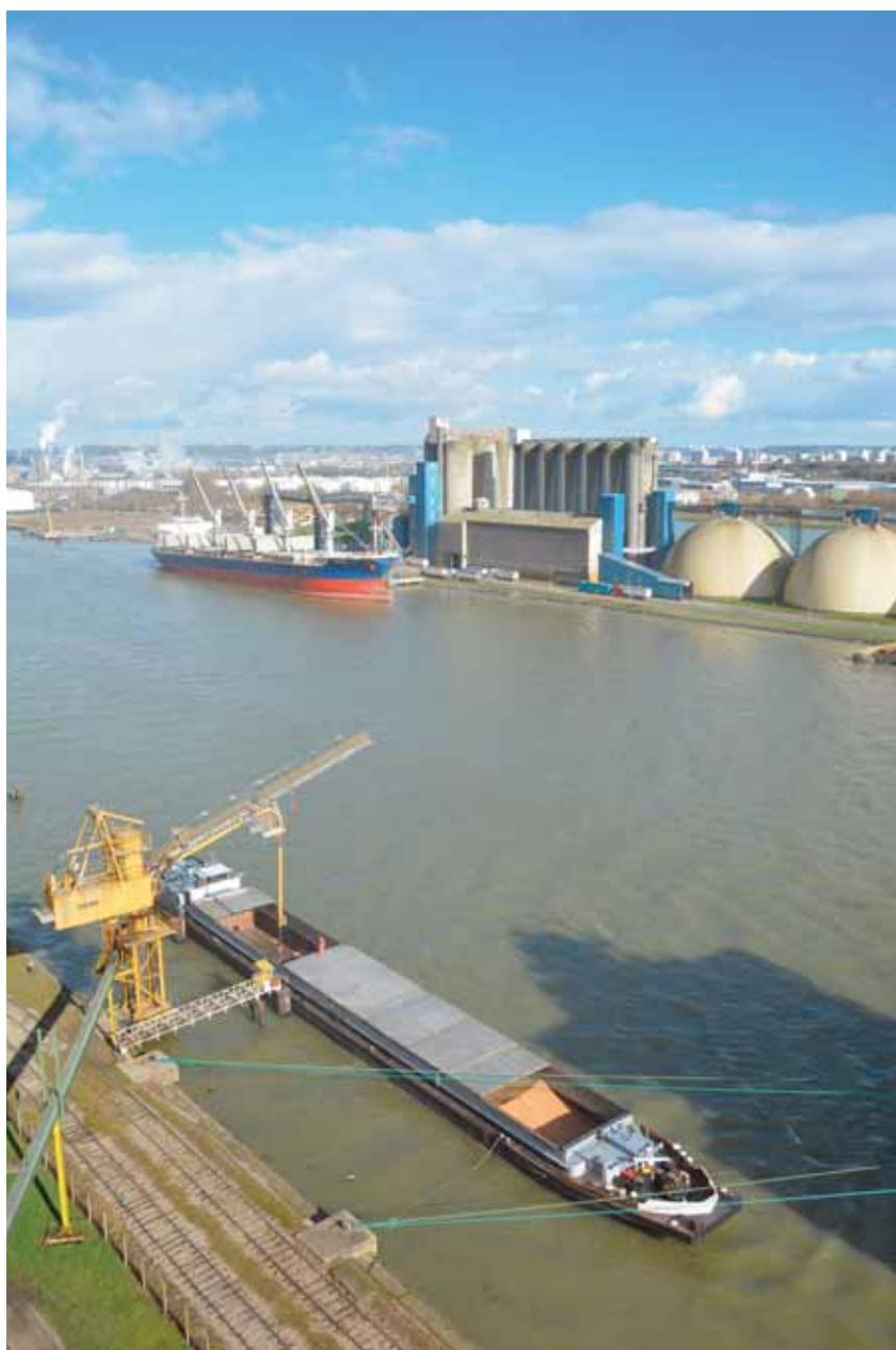
Déchargement d'une péniche par aspiration (au 1<sup>er</sup> plan) et chargement d'un navire à Rouen
